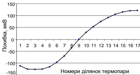
Рис. 2. Похибка від набутої неоднорідності хромелевого електроду звичайної ТП
